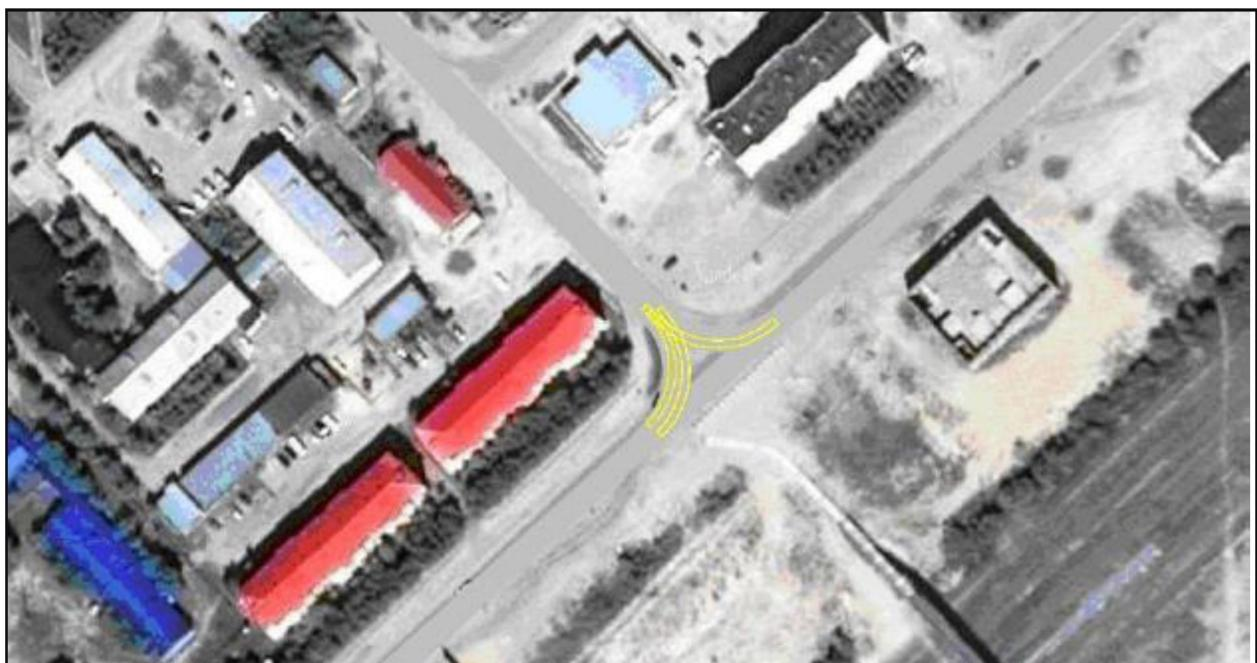
**Рисунок 46. Зоны малоскоростного движения на пересечении**
